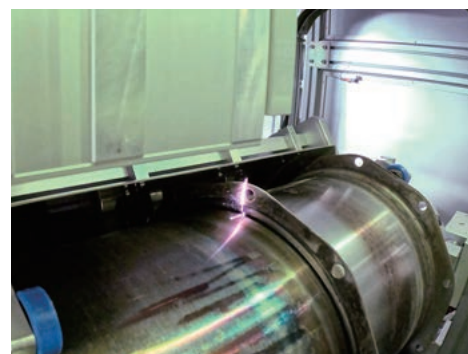
▶ 錆の除去（レーザー）
